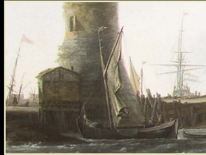
Een Wydschip. Voorzien van een staand gaffeltuig. Het wydschip is de grotere zuster van het smalschip. Zie ets Reinier Nooms, genaamd Zeeman, ca. 1623-1664 uit de serie (36 st) etsen. Verscheijde Schepen en Gesichten van Amstelredam, Naer t leven afgetekent en opt Cooper gebracht, door Reinier Nooms, al'as zeeman . Eerste deel A.11.
