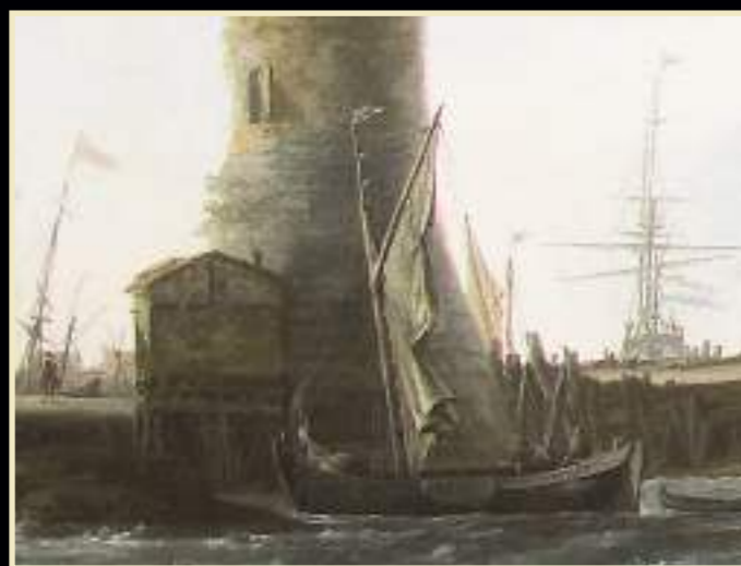
Een Wydtschip. Voorzien van een staand gaffeltuig. Het wydtschip is de grotere zuster van het smalschip. Zie ets Reinier Nooms, genaamd Zeeman, ca. 1623-1664 uit de serie (36 st) etsen. Verscheijde Schepen en Gesichten van Amstelredam, Naer t leven afgetekent en opt Cooper gebracht, door Reinier Nooms, al'as zeeman . Eerste deel A.11.
